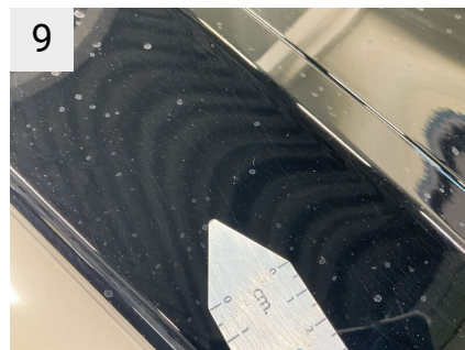
9 Sted H. forskærm Del Skærm Type Stenslag flere
