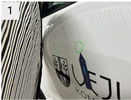
Sted V. fordør Del Dør Type Bule(r)
