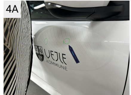
4A Sted H. fordør Del Dør Type Bule(r)
