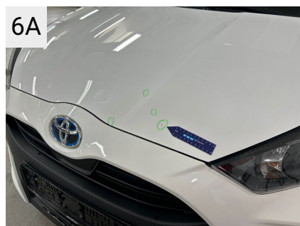
6A Sted Motorhjem Del Hjelm Type Stenslag flere
