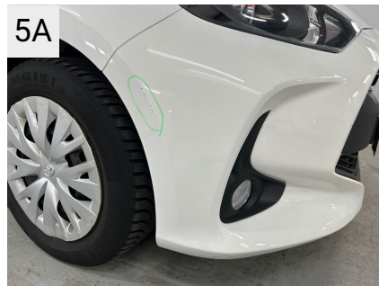
5A Sted Front Del Forkofanger Type Ridser
