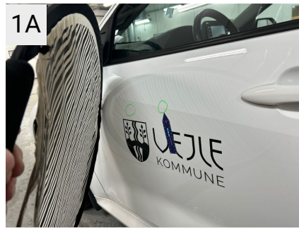
Sted V. fordør Del Dør Type Bule(r)
