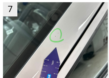
7 Sted V. A-stolpe Del Stolpe Type Stenslag
