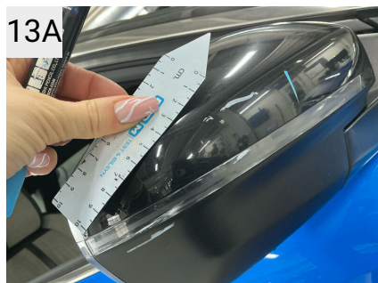
13A Sted H. fordør Del Spejl hus Type Ridser
