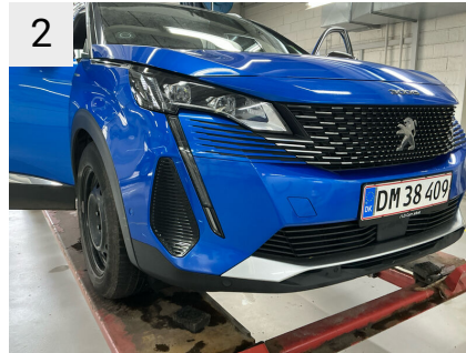
2 Sted Front Del Forkofanger Type Ridser
