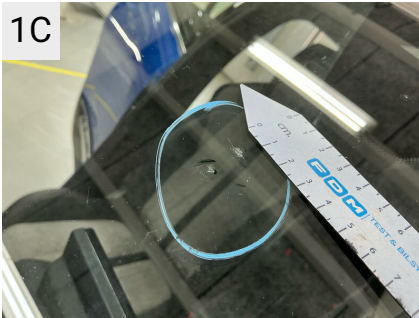
1C Sted Forrude Del Rude Type Stenslag
