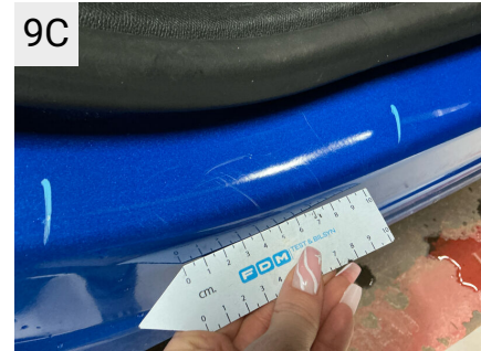
9C Sted H. panel Del Indstigning Højre Bag Type Bulet/Ridset
