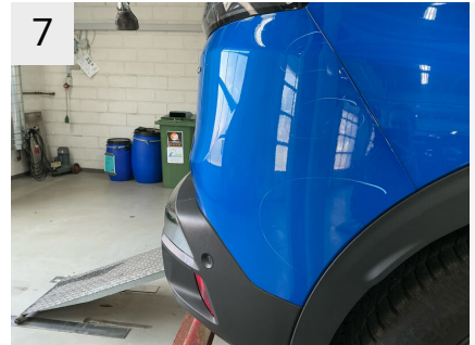
7 Sted Bagkofanger Del Kofanger Type Ridser
