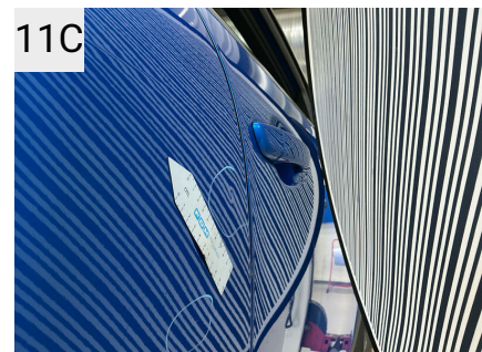
11C Sted H. bagdør Del Dør Type Bulet/Ridset
