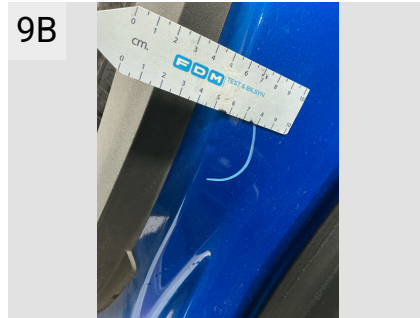
9B Sted H. panel Del Indstigning Højre Bag Type Bulet/Ridset
