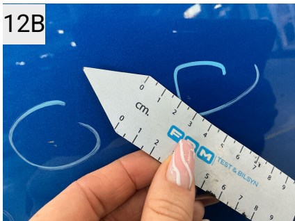
12B Sted H. fordør Del Dør Type Ridser
