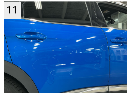
11 Sted H. bagdør Del Dør Type Bulet/Ridset
