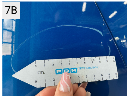
7B Sted Bagkofanger Del Kofanger Type Ridser
