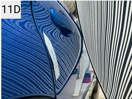
11D Sted H. bagdør Del Dør Type Bulet/Ridset
