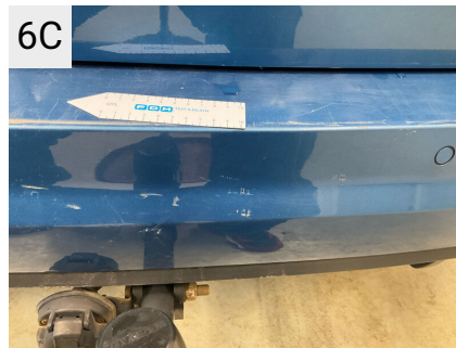
6C Sted Bagkofanger Del Kofanger Type Ridser
