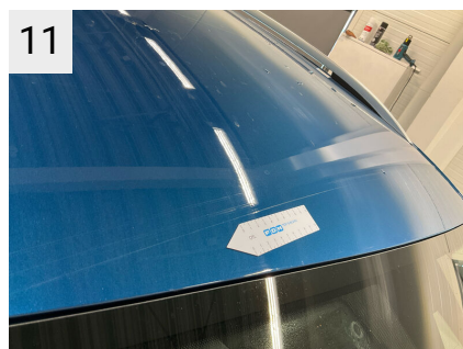
11 Sted Tag Del Tagplade Type Ridser
