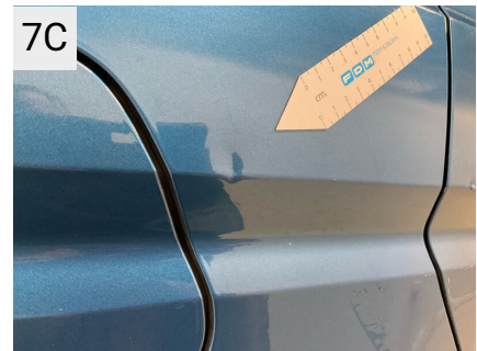
7C Sted H. bagskærm Del Skærm Type Bulet/Ridset
