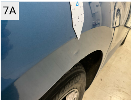
7A Sted H. bagskærm Del Skærm Type Bulet/Ridset
