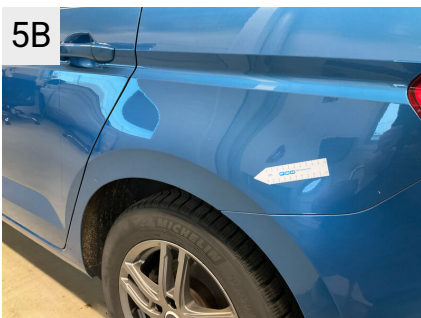
5B Sted V. bagskærm Del Skærm Type Ridser
