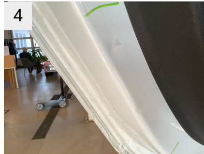
4 Sted V. bagdør Del Dør Type Bule(r)
