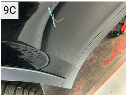
9C Sted H. bagdør Del Dør Type Bulet/Ridset
