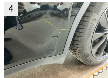
4 Sted V. bagdør Del Dør Type Stenslag flere
