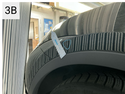
3B Sted V. forskærm Del Skærm Type Bule(r)
