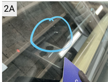
2A Sted Forrhude Del Rude Type Stenslag
