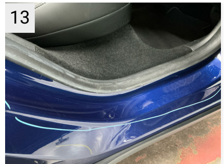
13 Sted H. panel Del Indstigning Højre Bag Type Ridser
