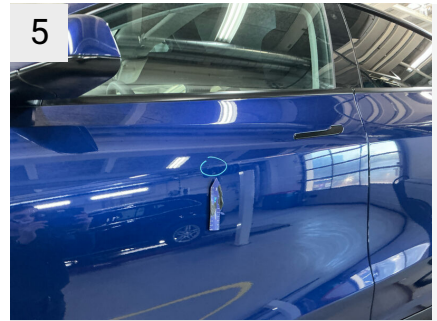
5 Sted V. fordør Del Dør Type Bule(r)
