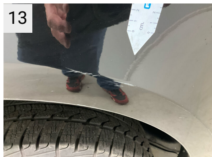
13 Sted H. bagskærm Del Skærm Type Ridser
