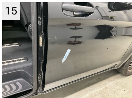
15 Sted H. fordør Del Dør Type Bulet/Ridset
