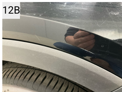
12B Sted H. forskærm Del Skærm Type Ridser
