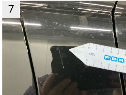
7 Sted H. bagskærm Del Skærm Type Ridser
