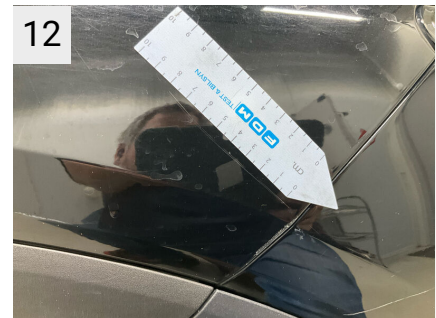
12 Sted H. forskærm Del Skærm Type Ridser
