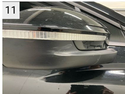
11 Sted H. fordør Del Side spejl Type Ridser
