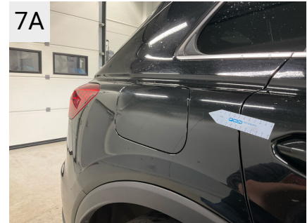
7A Sted H. bagskærm Del Skærm Type Ridser
