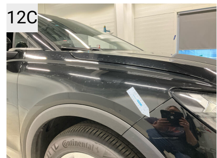
12C Sted H. forskærm Del Skærm Type Ridser
