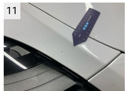
11 Sted H. forskærm Del Skærm Type Stenslag flere
