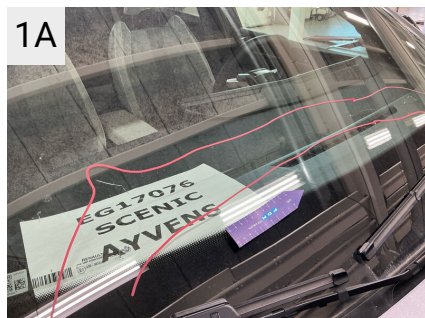
1A Sted Forrude Del Rude Type Revne
