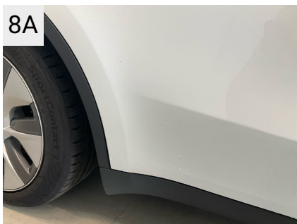
8A Sted H. bagdør Del Dør Type Stenslag flere
