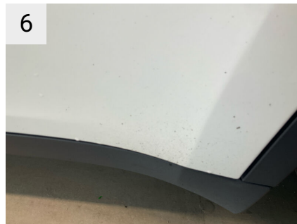
6 Sted V. bagdør Del Dør Type Stenslag flere
