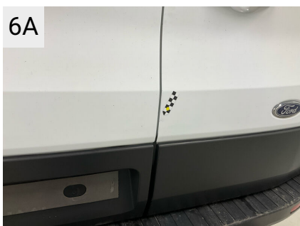
6A Sted Bagklap Del Højre bagdør Type Bulet/Ridset
