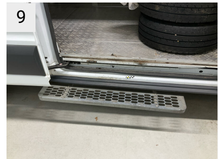
9 Sted H. panel Del Indstigning Højre Bag Type Bulet/Ridset
