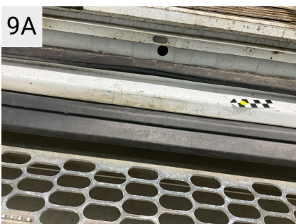
9A Sted H. panel Del Indstigning Højre Bag Type Bulet/Ridset
