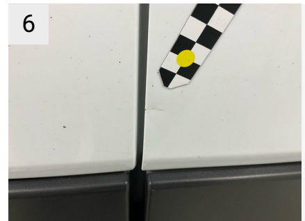
6 Sted Bagklap Del Højre bagdør Type Bulet/Ridset
