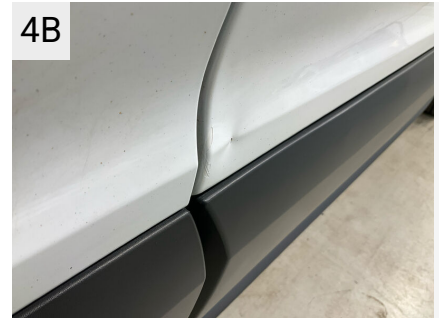
4B Sted V. bagskærm Del Sidevæg Type Bulet/Ridset
