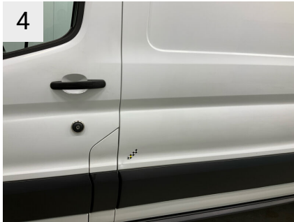
4 Sted V. bagskærm Del Sidevæg Type Bulet/Ridset
