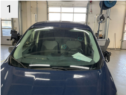
1 Sted Forrude Del Rude Type Stenslag
