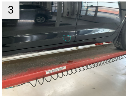
3 Sted V. fordør Del Dør Type Bule(r)
