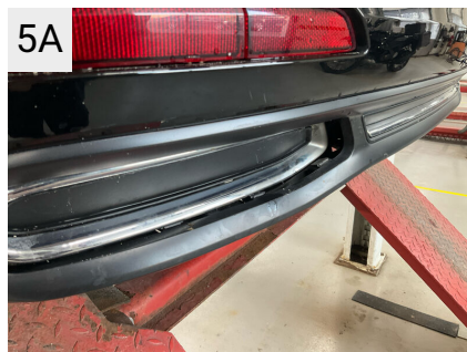
5A Sted Bagkofanger Del Pyntegitter Type Defekt
