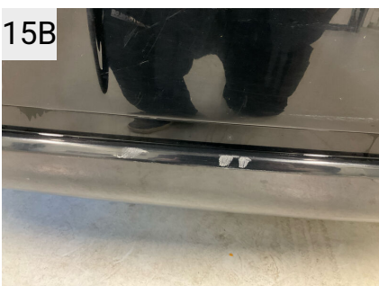
15B Sted Bagkofanger Del Kofanger Type Ridser
