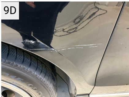
Sted V. forskærm Del Skærm Type Revnet
