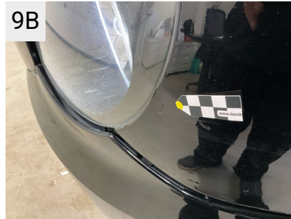
Sted V. forskærm Del Skærm Type Revnet
