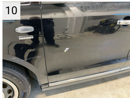
Sted V. fordør Del Dør Type Ridser
