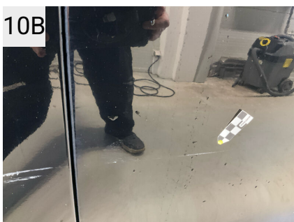
Sted V. fordør Del Dør Type Ridser
