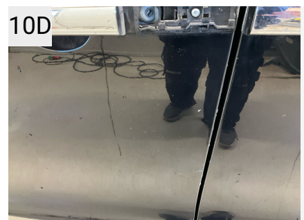
Sted V. fordør Del Dør Type Ridser
