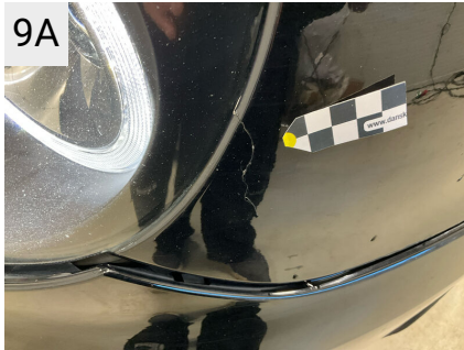
Sted V. forskærm Del Skærm Type Revnet
