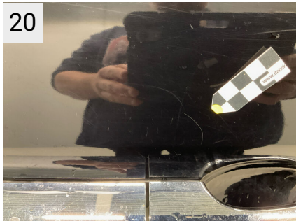
20 Sted H. fordør Del Dør Type Ridser
