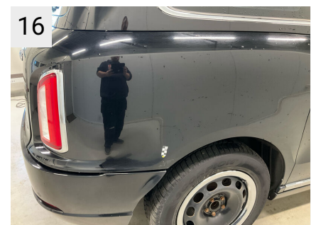
16 Sted H. bagskærm Del Skærm Type Ridser
