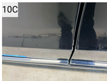
Sted V. fordør Del Dør Type Ridser
