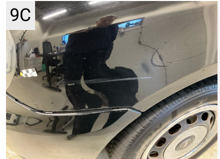
Sted V. forskærm Del Skærm Type Revnet
