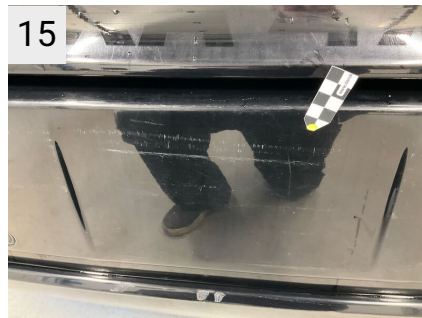
15 Sted Bagkofanger Del Kofanger Type Ridser
