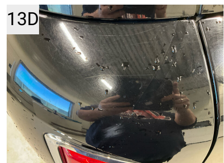
13D Sted V. bagskærm Del Skærm Type Ridser
