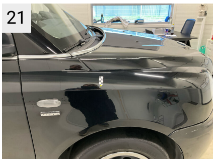
21 Sted H. forskærm Del Skærm Type Ridser
