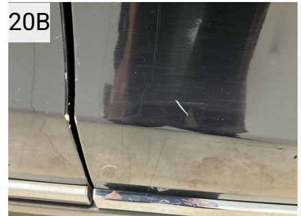
20B Sted H. fordør Del Dør Type Ridser
