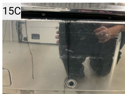
15C Sted Bagkofanger Del Kofanger Type Ridser
