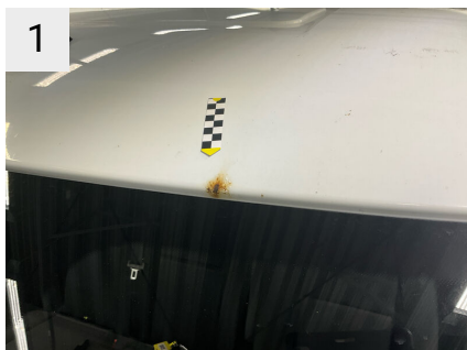
1 Sted Tag Del Tagplade Type Rust plet
