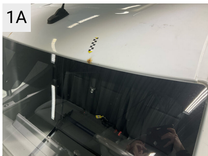
1A Sted Tag Del Tagplade Type Rust plet
