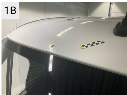
1B Sted Tag Del Tagplade Type Rust plet
