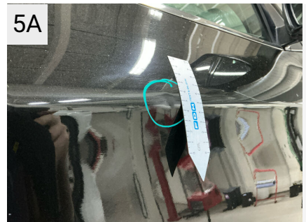
5A Sted H. fordør Del Dør Type Bule(r)
