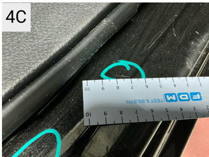
4C Sted H. panel Del Indstigning Højre Bag Type Rids
