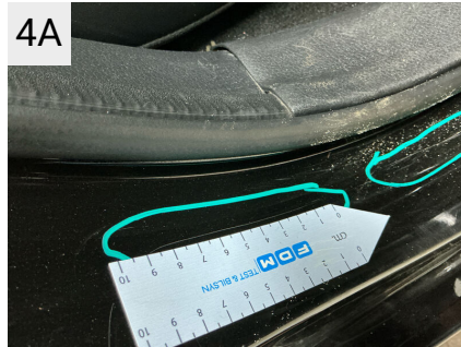
4A Sted H. panel Del Indstigning Højre Bag Type Rids
