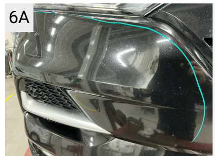
6A Sted Front Del Forkofanger Type Stenslag flere
