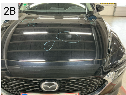
2B Sted Motorhjem Del Hjelm Type Bulet/Ridset
