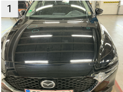
1 Sted Motorhjem Del Emblem Type Ætsning i lak fra kemikalier/fugleklatte
