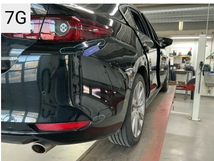
7G Sted Bagkofanger Del Kofanger Type Bulet/Ridset
