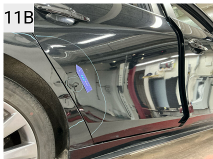
11B Sted H. bagdør Del Dør Type Bulet/Ridset
