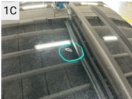
1C Sted Motorhjem Del Emblem Type Ætsning i lak fra kemikalier/fugleklatte
