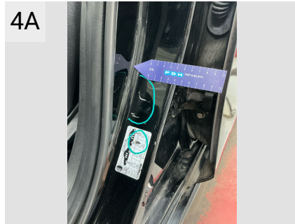
4A Sted V. fordør Del B-stolpe Type Bulet/Ridset
