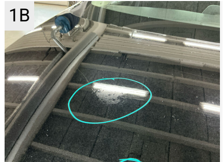
1B Sted Motorhjem Del Emblem Type Ætsning i lak fra kemikalier/fugleklatte
