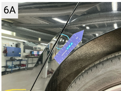
6A Sted V. bagskærm Del Skærm Type Bule(r)
