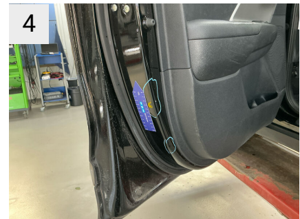
4 Sted V. fortdør Del Dør Type Bule(r)
