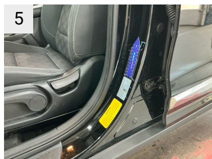
5 Sted V. fortdør Del B-stolpe Type Bulet/Ridset
