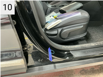
Sted H. fordør Del Dørkant Type Bule(r)
