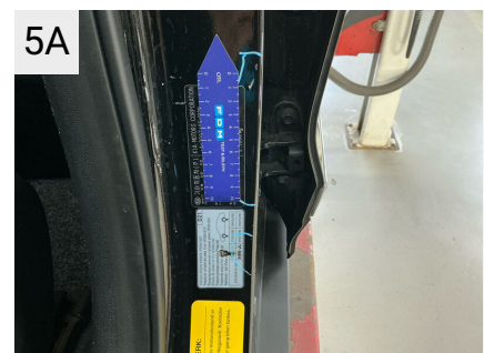
5A Sted V. fortdør Del B-stolpe Type Bulet/Ridset
