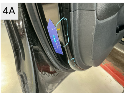
4A Sted V. fortdør Del Dør Type Bule(r)
