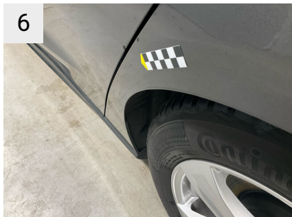
6 Sted V. bagskærm Del Skærm Type Bule(r)
