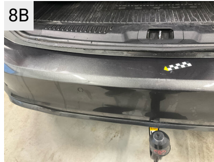
8B Sted Bagkofanger Del Kofanger Type Ridser
