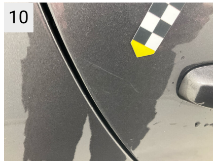
10 Sted H. bagdør Del Dør Type Ridser
