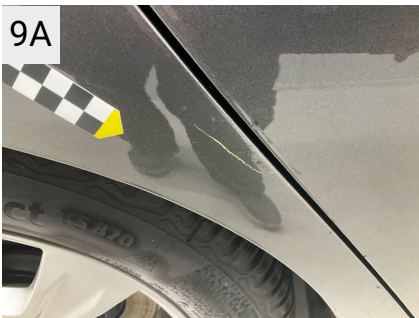
9A Sted H. bagskærm Del Skærm Type Ridser
