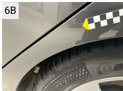
6B Sted V. bagskærm Del Skærm Type Bule(r)
