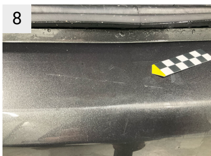
8 Sted Bagkofanger Del Kofanger Type Ridser
