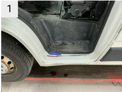
1 Sted V. fordør Del Dør Type Ridser
