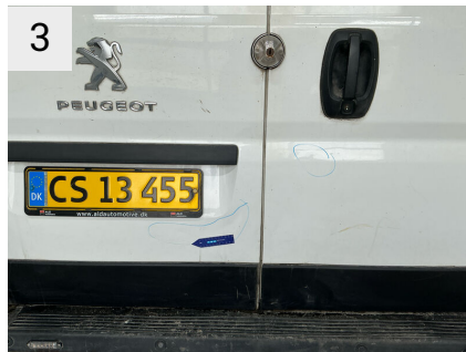
3 Sted Bagklap Del Fløjdør Begge Type Bule(r)
