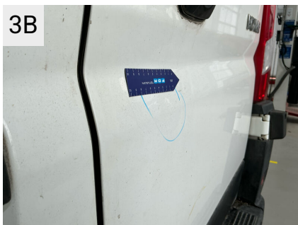
3B Sted Bagklap Del Fløjdør Begge Type Bule(r)
