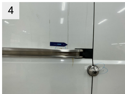
4 Sted H. bagskærm Del Skærm Type Rust plet
