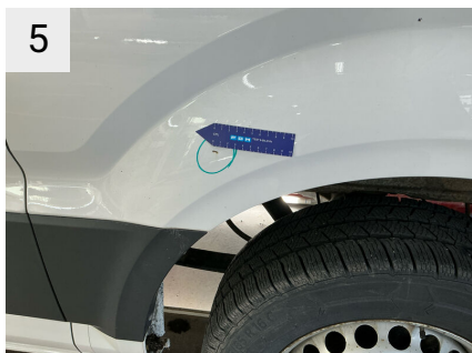
5 Sted V. bagskærm Del Skærm Type Rust plet
