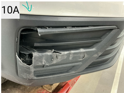
Sted Front Del Kølegitter Type Skadet
