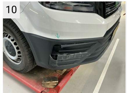
Sted Front Del Kølegitter Type Skadet
