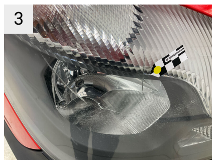
3 Sted Front Del Forlygter, Højre Type Revnet
