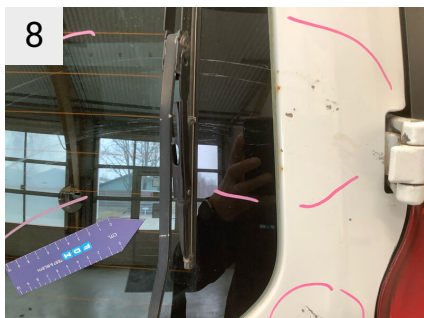
8 Sted Bagklap Del Fløjdør Højre Type Ridser
