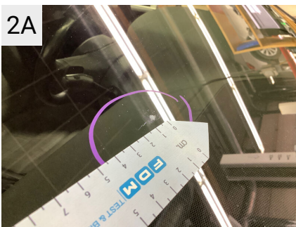
2A Sted Forrude Del Rude Type Revne
