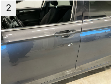
2 Sted V. fordør Del Dør Type Bule(r)
