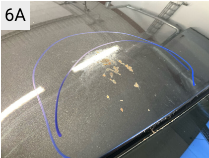
6A Sted Tag Del Tagplade Type Ætsning i lak fra kemikalier/fugleklatter
