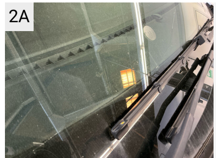
2A Sted Forrude Del Rude Type Revne
