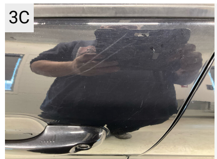
3C Sted V. fordør Del Dør Type Bulet/Ridset
