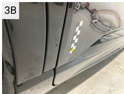
3B Sted V. fordør Del Dør Type Bulet/Ridset
