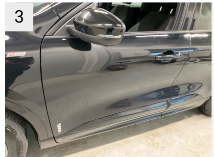
3 Sted V. fordør Del Dør Type Bulet/Ridset
