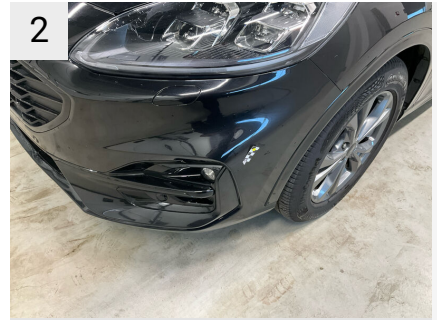
2 Sted Front Del Forkofan- Type Revnet
