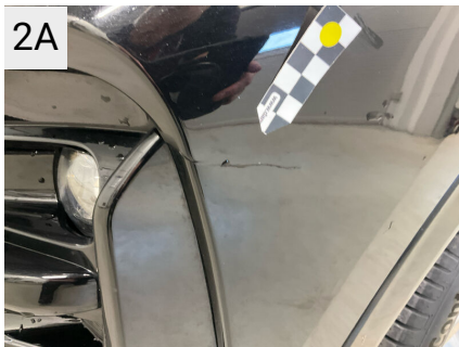
2A Sted Front Del Forkofan- Type Revnet
