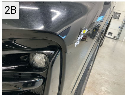
2B Sted Front Del Forkofan- Type Revnet
