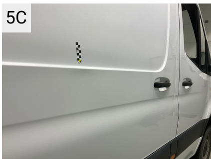
5C Sted H. bagdør Del Skydedør Type Bule(r)
