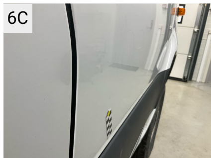
6C Sted H. fordør Del Dør Type Bule(r)
