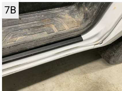
7B Sted H. panel Del Indstigning Højre For Type Ridser
