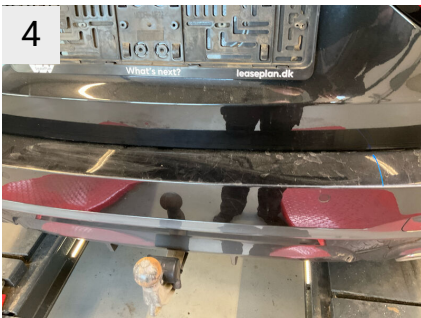
Sted Bagkofanger Del Kofanger Type Ridser
