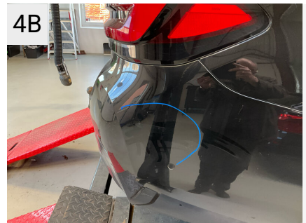
Sted Bagkofanger Del Kofanger Type Ridser
