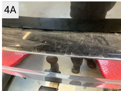
Sted Bagkofanger Del Kofanger Type Ridser
