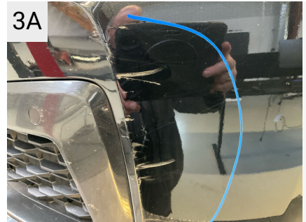
Sted Front Del Forkofanger Type Ridser
