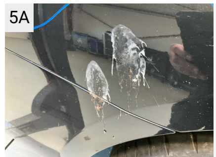
Sted H. bagskærm Del Skærm Type Ætsning i lak fra kemikalier/fugleklatte
