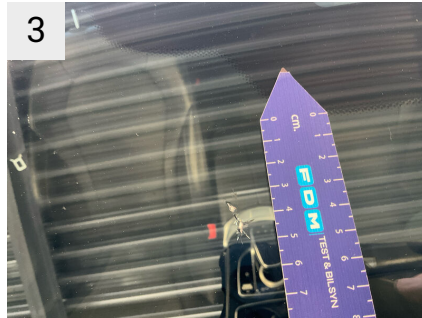
3 Sted Forrude Del Rude Type Stenslag
