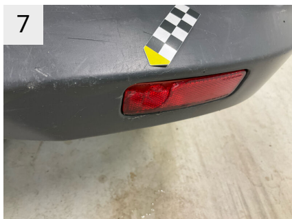
7 Sted Bagkofanger Del Refleks, Højre Type Revnet
