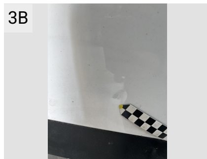
3B Sted Bagklap Del Højre bagdør Type Rust plet
