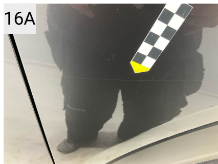
16A Sted H. forskærm Del Skærm Type Ridser
