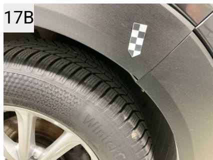
17B Sted H. forskærm Del Pynteliste Type Revnet
