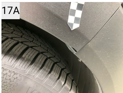
17A Sted H. forskærm Del Pynteliste Type Revnet
