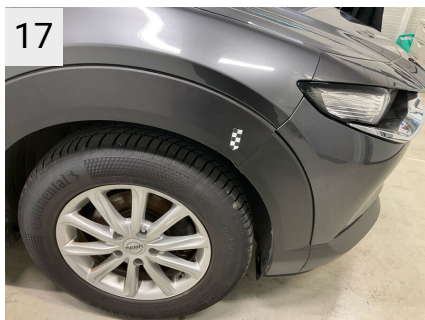
17 Sted H. forskærm Del Pynteliste Type Revnet
