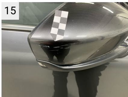
15 Sted H. fordør Del Side spejl Type Ridser
