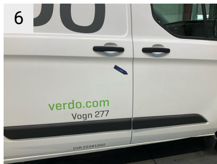
6 Sted H. bagdør Del Dør Type Ridser
