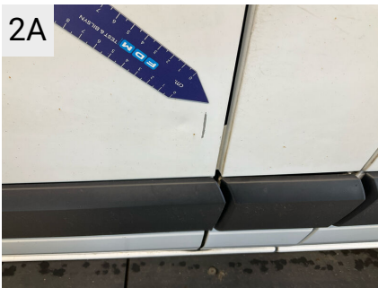
2A Sted V. forlørd Del Dør Type Ridser
