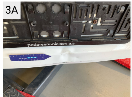
3A Sted Bagklap Del Fløjdør Venstre Type Bulet/Ridset
