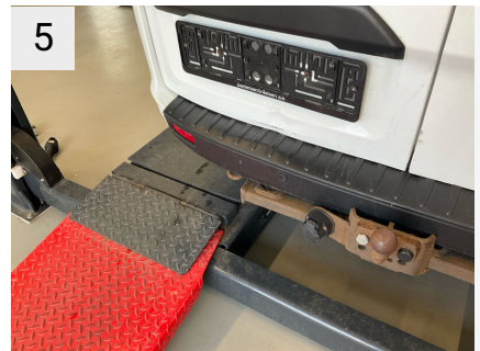
5 Sted Bagkofanger Del Kofanger Type Bulet/Ridset
