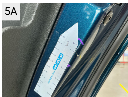
5A Sted H. bagdør Del Dør Type Bulet/Ridset
