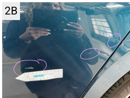
2B Sted V. bagdør Del Dør Type Ridser
