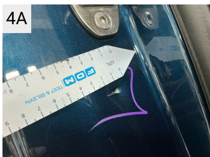
4A Sted H. panel Del Indstigning Højre Bag Type Bulet/Ridset
