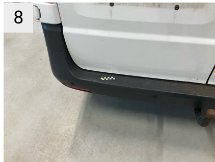
8 Sted Bagkofanger Del Kofanger Type Bulet/Ridset
