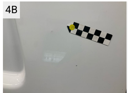
4B Sted V. bagskærm Del Skærm Type Bule(r)
