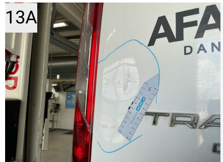
13A Sted Bagklap Del Fløjdør Venstre Type Bulet/Ridset
