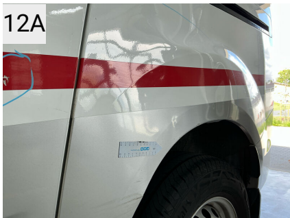
12A Sted V. bagskærm Del Sidevæg Type Bule(r)
