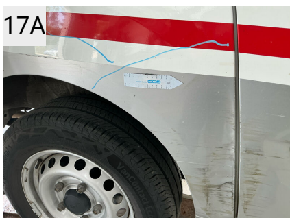
17A Sted H. bagskærm Del Sidevæg Type Bulet/Ridset
