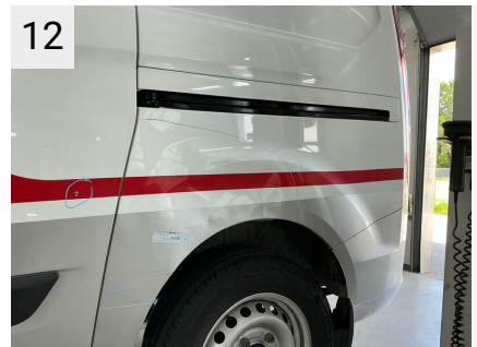
12 Sted V. bagskærm Del Sidevæg Type Bule(r)
