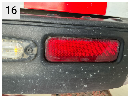
16 Sted Bagkofanger Del Refleks, Højre Type Revnet
