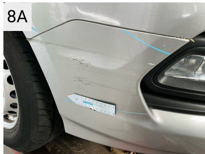
8A Sted Front Del Forkofanger Type Ridser
