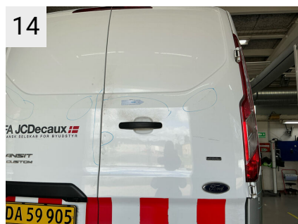
14 Sted Bagklap Del Fløjdør Højre Type Bulet/Ridset
