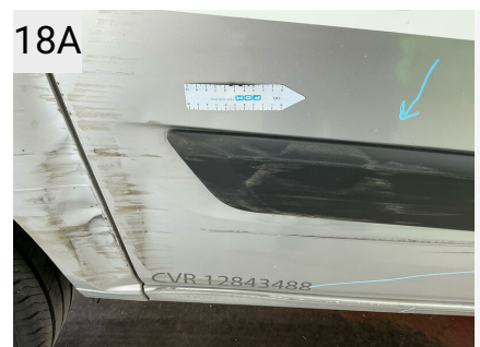
18A Sted H. bagdør Del Skydedør Type Bulet/Ridset
