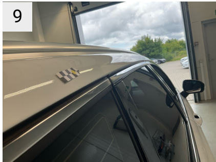
9 Sted H. A-stolpe Del Stolpe Type Bule(r)
