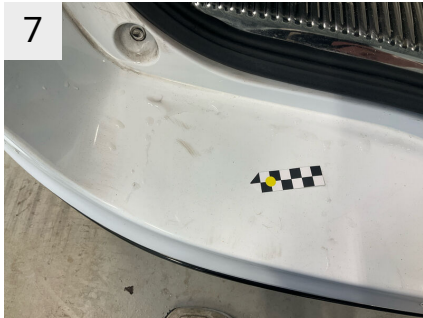
7 Sted Bagkofanger Del Kofanger Type Ridser
